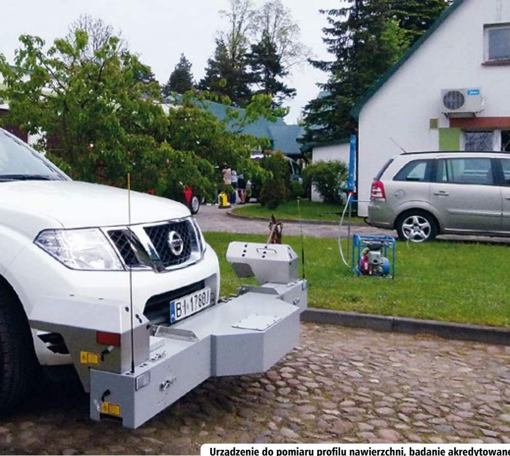
Urządzenie do pomiaru profilu nawierzchni, badanie akredytowane
